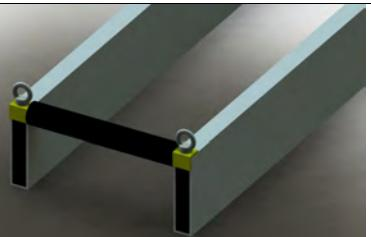
Далее следует закрепить заглушки. Для этого берем саморезы и в намеченные отверстия вкручиваем их.
