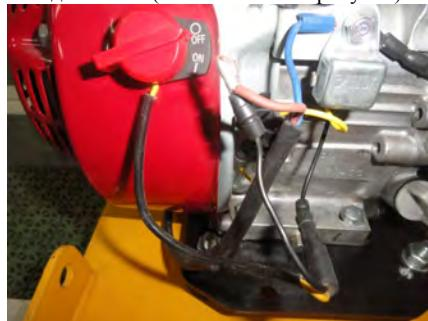
Соединяем защитный колпачок.
