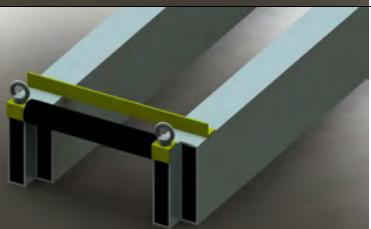
Далее следует закрепить заглушки. Для этого берем саморезы и в намеченные отверстия вкручиваем их.
