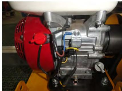
Отсоединив защитный колпачок датчика, подключаем оголенную жилу рычага к проводу датчика остановки двигателя (как показано на рисунке).
