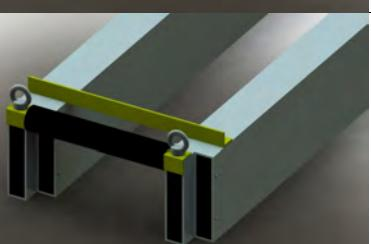
Повторяем эти операции с другой стороны и получаем профили в сборе. Теперь устанавливаем площадку на профили, выравниваем ее по-центру профилей и закручиваем фиксирующие болты с контргайками.
