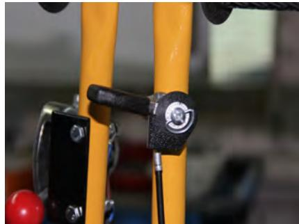
Проверяем ход рычага оборотов двигателя. Если рычаг оборотов двигателя не перемещается, то следует проверить гайку или укоротить трос. После регулировки устанавливаем воздушный фильтр и корпус фильтра обратно.
