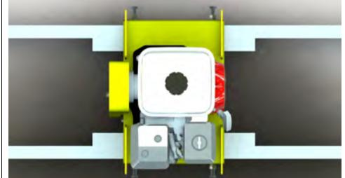
После того, как площадка выровняна закручиваем фиксирующие болты с контргайками.
