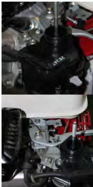
Далее, как показано на рисунке, устанавливаем тросик регулятора оборотов двигателя. Ослабляем гайку рычага оборотов двигателя (гайка обведена в красный круг) так, чтобы при увеличении оборотов двигателя рычаг без затруднений перемещался на нас, а при уменьшении оборотов двигателя рычаг с помощью пружины перемещался в первоначальное положение.
