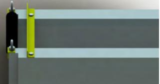
Все эти процедуры повторяем с другой стороны, выравниваем профили и закручиваем. После закручивания можно приступать к установке заглушек. В комплекте идут два типа заглушек: со скосами и без скосов.
